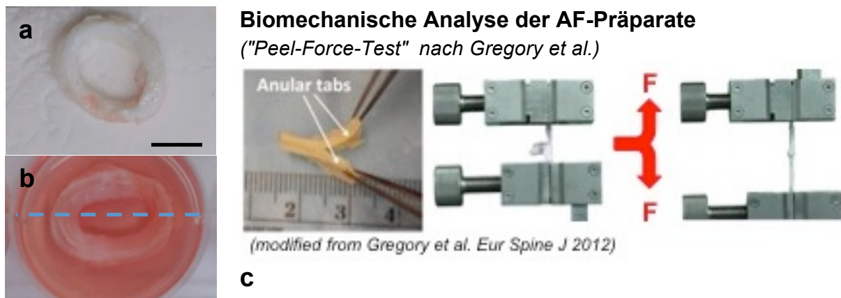
Abb. 4: Die Bestimmung der mechanischen Eigenschaften der AF-Präparate (a) in einer Hälfte eines AF-Ring-Präparates (b) mit Hilfe des sogenannten „ Peel-Force-Tests “ (c). Die Delaminationskraft, die erforderlich ist, um benachbarte AF-Lamellen voneinander zu trennen, wurde analysiert. Dazu wurden die Proben zwischen zwei Lamellen Y-förmig mit einem Skalpell angeschnitten und die beiden Enden der Proben (Anular tabs) wurden mit Hilfe einer Materialprüfmaschine von einander getrennt (c).
